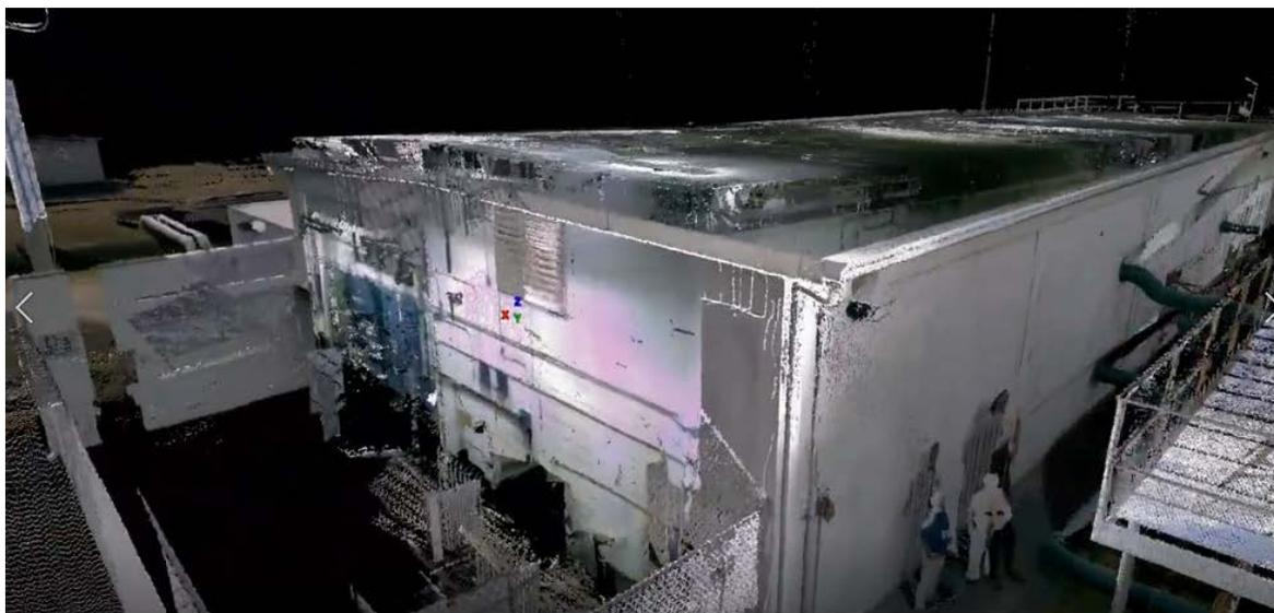
Levantamiento 3D con Láser escáner BLK360 SALON DE REFRIGERACIÓN
