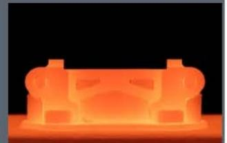
A medida que la pieza se calienta a temperaturas cercanas a la fusión, se elimina el aglomerante restante y las partículas de metal se fusionan, lo que hace que la pieza se densifique hasta el 96-99.8%.
