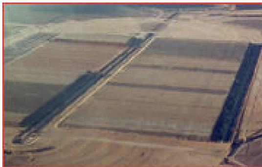
Pilas de lixiviación de Radomiro Tomic, de dimensiones 1300 m de largo por 380 m de ancho, con un apilamiento de 10 m de altura y un ángulo de reposo del material de 37°.
